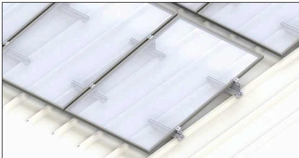
In corrispondenza dell'inizio e fine di ogni fila di pannelli prevedere da ambo i lati del profilo alzata piccola e alzata grande, una vite di bloccaggio.
